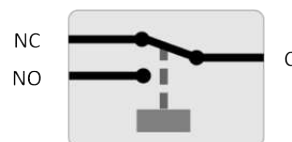
Configuración del relé (sin corriente)
